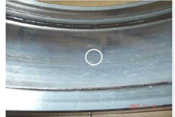
Визуальный контроль. По внешнему виду дефект имеет вид кратера, при рассмотрении с использованием увеличительного стекла доньшко кратера темного или серого цвета со следами оплавления.
