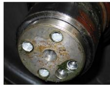
Механическое повреждение резьбы М12 осей РУ1
